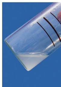
④ 検水をシリンジで吸引・除去後、凝固体を再溶解します。
