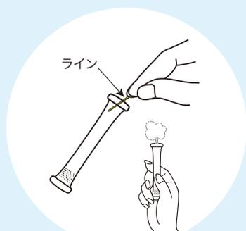
1 ラインを引き抜き中の空気を抜く
