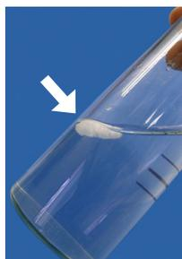
③ 油分を捕捉したポリニッパムが凝固します。
