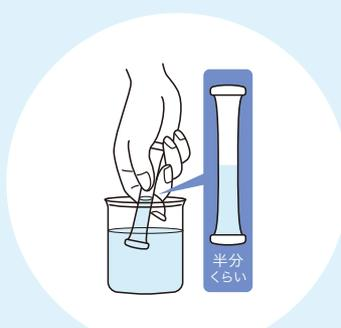
2 先端の穴から検水を1.5mL吸い込む
