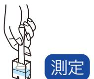
試薬と検水を混合し、同時に【測定】を押します。
