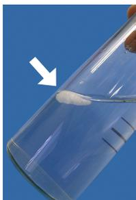
③ 油分を捕捉したポリニッパムが凝固します。
