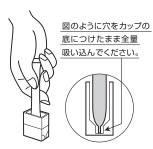
⑥そのまま⑤の状態で、穴を 検水の中に入れ、つまんだ指を ゆるめ、専用カップの検水を 全量吸い込みます。
