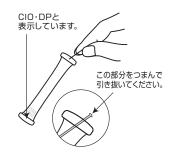
④パックテストのチューブ先端 のラインを引き抜きます。
