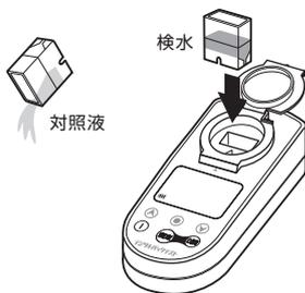
④ 対照液を捨てて、検水を専用カップの標線
