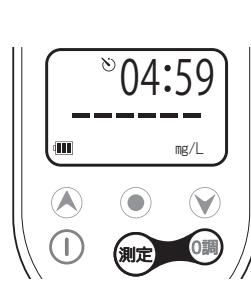
⑪⑫と同時に測定ボタンを押します。カウントダウンが始まります。
