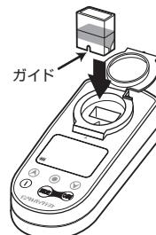
③長押しで電源を入れ、専用カップのガイドが手前になるように測定部にセットします。
