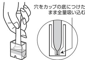
⑥ そのまま穴を検水の中に入れ、つまんだ指をゆるめ、専用カップの検水を全量吸い込みます。
