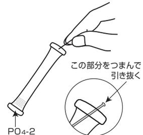
④ チューブ先端のラインを引抜きます。
