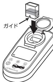
② 専用カップのガイドが手前になるように測定部にセットします。
