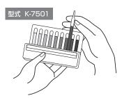
アンプルを標準比色管に密着させ、 目の高さで比色します。
