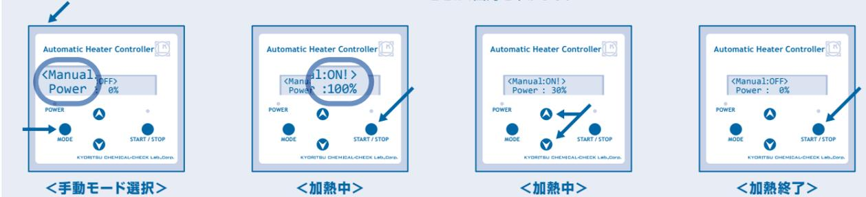
**注意** 蒸留中に異常を確認した場合には、すぐに加熱を止め、冷めるまで放置してください。加熱は自動で止まりません。15分間で必ず加熱を止めてください。空焚きになるおそれがあり大変危険です。
