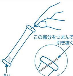
③ チューブ先端のラインを引き抜きます。
