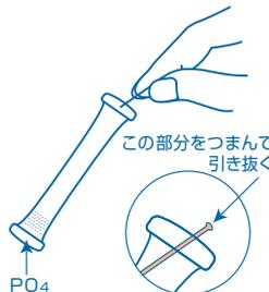
③ チューブ先端のラインを引き抜きます。
