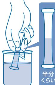
③そのまま穴を検水の中に入れ、つまんだ指をゆるめ、半分くらい水を吸い込むまで待ちます。液がもれないようにかるく5~6回振り混ぜます。
