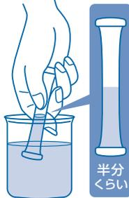
③ そのまま穴を検水の中に入れ、つまんだ指をゆるめ、半分くらい水を吸い込むまで待ちます。液がもれないようにかるく5~6回振り混ぜます。
